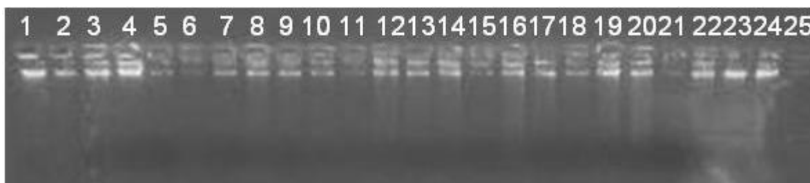
Figura 7: Gel de agarose a 0,8% corado com brometo de etídio a 10 mg.mL -1 após eletroforese em cuba horizontal a 80 volts por 40 minutos. Nos poços 1 e 2 estão as amostras de DNA extraído dos genitores (TSH 1188 e CCN 51), e nos poços de 3 a 25 estão algumas amostras dos DNAs da população F 1 .
