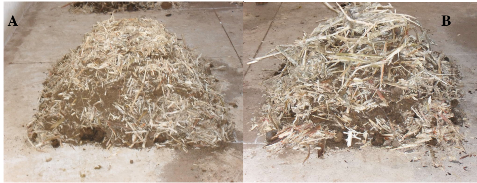
Figura 8 - Pilhas montadas no experimento de compostagem: Pilha com bagaço de cana triturado (A) e Pilha com bagaço de cana in natura (B)
